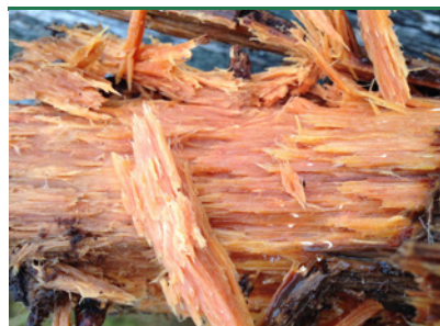
Mastesvamp - Nedbrudt træ. (Foto: Protox)
