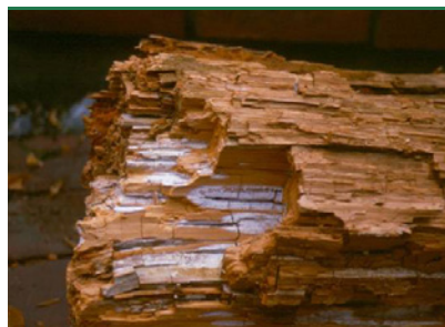
Hvid Tømmer-svamp - sprækkeklodser. (Foto: Goritas A/S)
