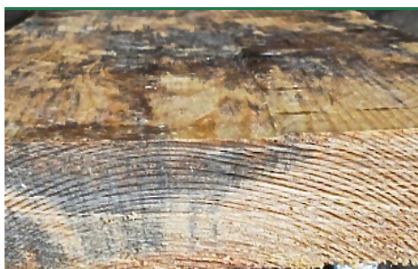
Blåsplint - angrebet nåletræ i marvstråler fra overfladen til træets kerne. (Foto: Prottox)
