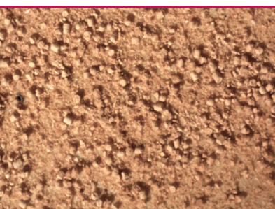
i 3 Husbuk - boremel med karakteristiske vinprop-formede ekskrementer. (Foto: Protox/Goritas arkiv)
