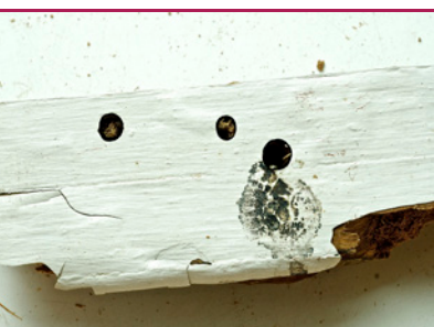
i 15 Rød Blomsterbuk - flyvehuller 5-8 mm skarpt kantede og runde. (Foto: Protox/Goritas arkiv)
