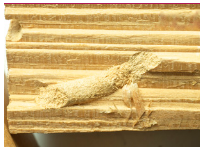
Træhveps - larvegang med hårdt pakket boremel. (Foto: Protox/Goritas arkiv)
