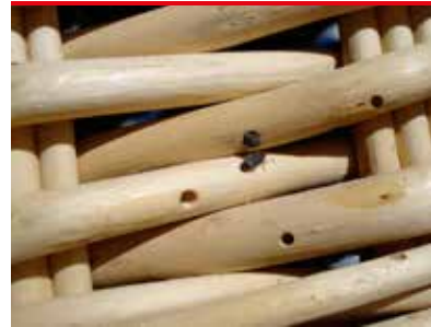
Strimmig trägnagare i korgmöbel i uterum (foto - Protox)
