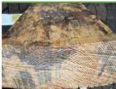
Blånad - observera djupgående missfärgning tvärs över årsringarna (foto - Protox)
