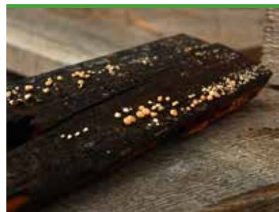
Rotplätt - fruktkroppar utomhus på trävirke (foto - Protox)
