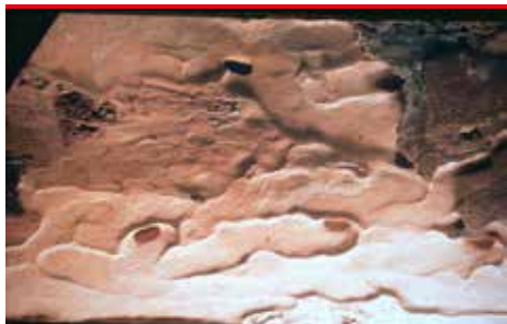
in 18 Blåhjon - gnagspår i barrträ mellan bark och tråets yttersta årsringar (foto - Hussvamp Laboratoriet)
