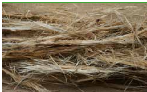
svn 52 Vitröta nedbrytning - okänd svamp (foto - Protox)
