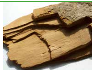
sv 8 Pulverskinn- bladig nedbrytning (svampskada) (foto - Protox/Goritas arkiv)
