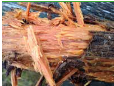
Opalporing – nedbrutet virke (foto - Protox)
