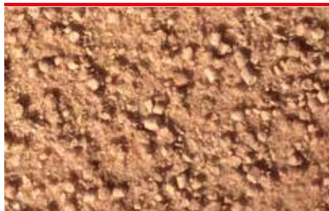
in 24 Husbock - bormjöl, notera karakteristiska korkformade ekskrementer (foto - Protox/Goritas arkiv)
