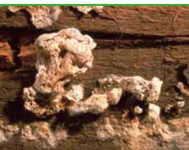
sv 15 Timmerticka - sterila fruktkroppar utvecklade i mörker (foto - Protox/Gori A/S)
