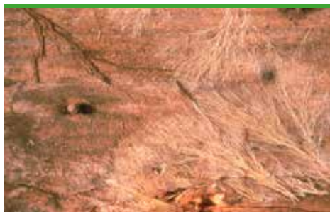
svn 31 Pulverskinn - karakteristiskt mörkt och ljust strängmycel (foto - Protox/Gori A/S)
