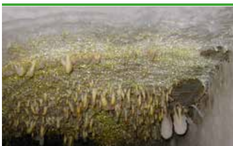
svn 28 Äkta Hussvamp- ytmycel med vattendroppar (foto - Bøgh & Helstrup)
